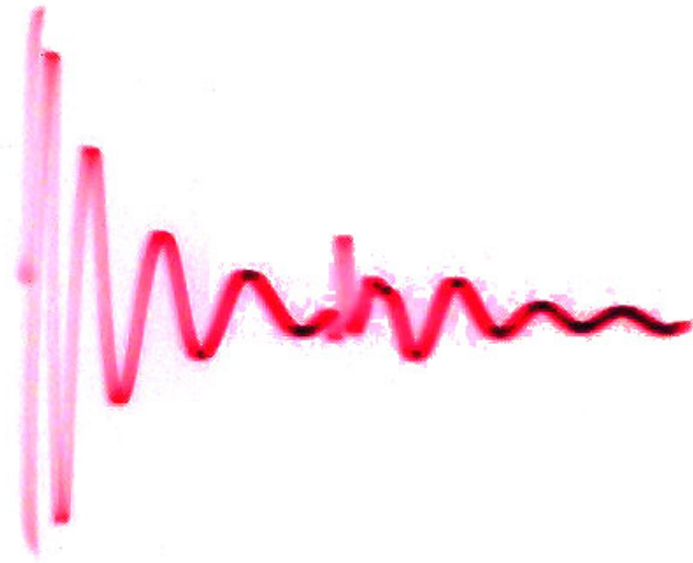
Рис. 15: Прямоугольный импульс после прохождения ВЧ-фильтра
